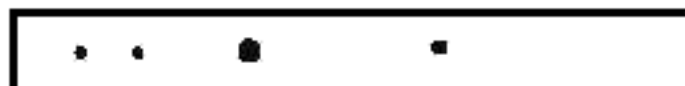
Пример 2 — Одна несплошность размером 3,2 мм, одна — 1,6 мм и две — по 0,8 мм каждая
