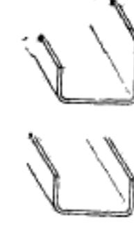
Сортовой гнутый профиль, образованный стenkой и двумя полками, расположеными по одному стыку от стеки под прямым углом.
