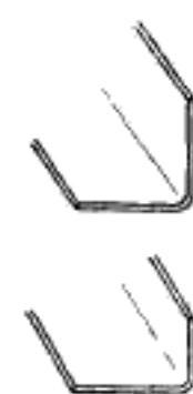
Сортовой гнутый профиль, образованный двумя полками, расположенными под прямым углом.
