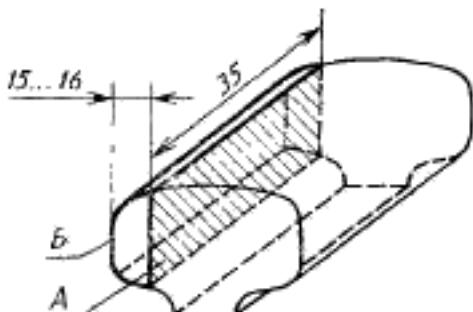
Примечание. Отклонение от параллельности поверхностей А и Б — не более 0,5 мм.
