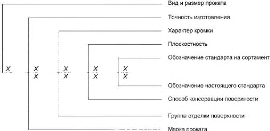
Прокат для эмалирования в листах толщиной 1,0 мм, шириной 1000 мм, длиной 2000 мм, нормальной точности изготовления Б, с необрзной кромкой НО, нормальной плоскости ПН, по ГОСТ 19904; марки 01, обычного качества отделки поверхности, промасленный ПР, по ГОСТ 24244:
